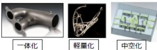
図7. 金属3Dプリンタ造形事例 (出典：タカノ社内資料より抜粋)
